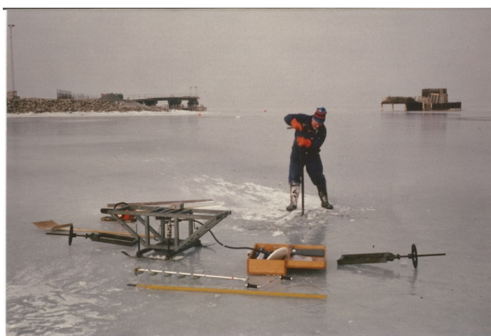
Is-undersøgelse ved Farøbroerne, februar 1982 (bøjningsstyrke r_f ) 10
